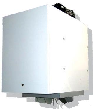
Воздухонагреватели АТV оснащены осевым вентилятором. Предназначены для направленной вертикальной подачи воздуха сверху вниз. Оснащены двухпозиционной настраиваемой жалюзийной решёткой. Можно использовать как для отопления, так и для дестратификации.
